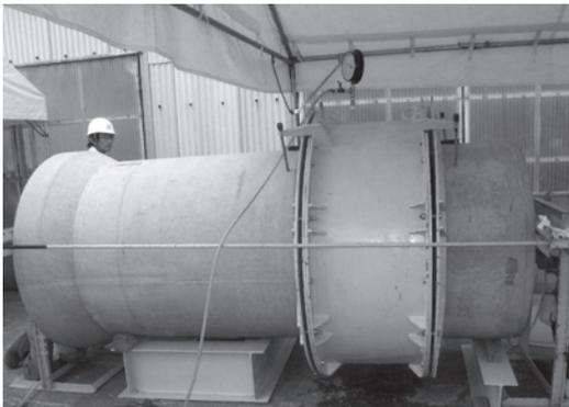
図-4 水密試験状況概要図
