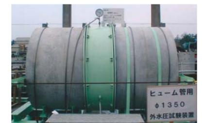
外水圧水密試験装置 全景
